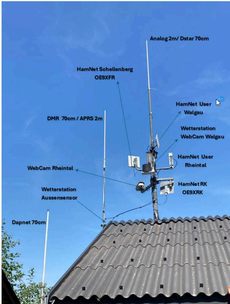
Am 07.12.2024 wurde das Problem mit der fehlerhaften Erkennung des 85.4 Hz CTCSS-Subaudiotons am Repeater OE9XVI behoben. Ab diesem Zeitpunkt wurde der CTCSS-Ton für RX/TX wieder zurück auf 85.4 Hz geändert, nachdem zuvor 77.0 Hz verwendet wurde. Die Arbeiten konnten vor dem Wintereinbruch durchgeführt werden. Der aktuelle Status von OE9XVI ist weiterhin auf QRZ.com einsehbar.
